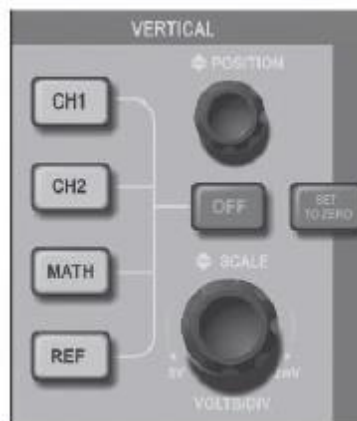
Fig. 3-13 Panoul de control vertical pentru osciloscopaele cu ecran de 5.7 inch
