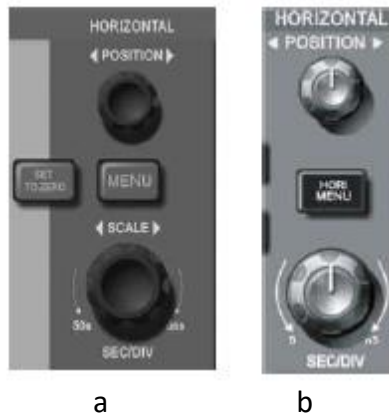
Fig. 2-11 Interfata pentru setare pe orizontala la osciloscopie cu ecran de: 5.7 inch (a) sau 7 inch (b)
