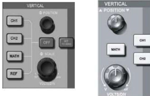
a. b. Fig. 1-9 Control vertical osciloscop: a. ecran de 5.7 inch b. ecran de 7 inch
