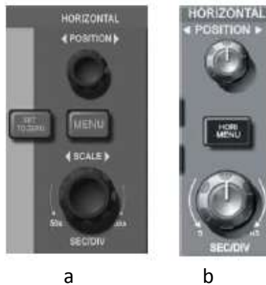
Fig. 2-11 Interfata pentru setare pe orizontala la osciloscopice cu ecran de: 5.7 inch (a) sau 7 inch (b)
