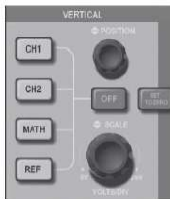
Fig. 3-13 Panoul de control vertical pentru osciloscopul cu ecran de 5.7 inch
