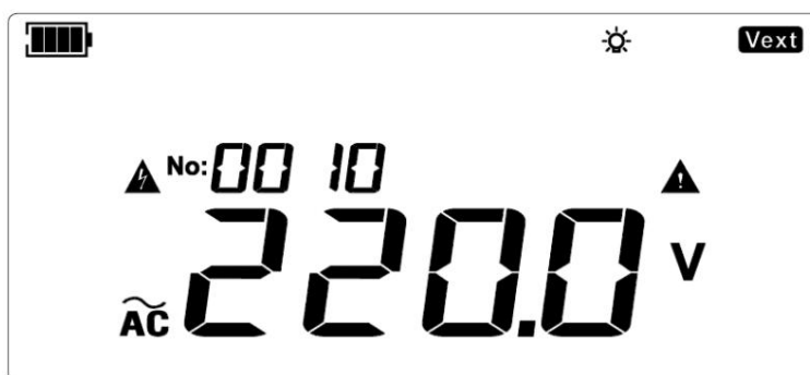
Figura 9.23 Măsurarea tensiunii alternative
