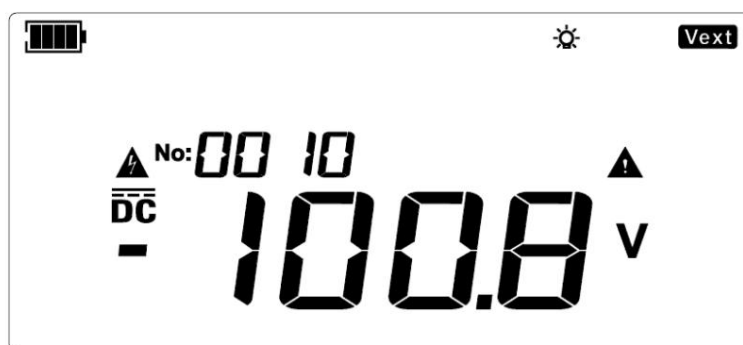
Figura 9.24 Măsurarea tensiunii continue negative
